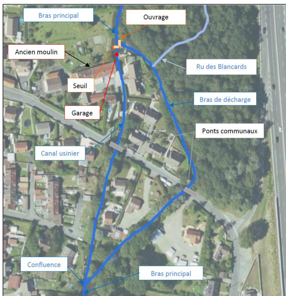
Figure 2 : Description du site hydraulique du moulin de la Commanderie (source Géoportail orthophotographies)
