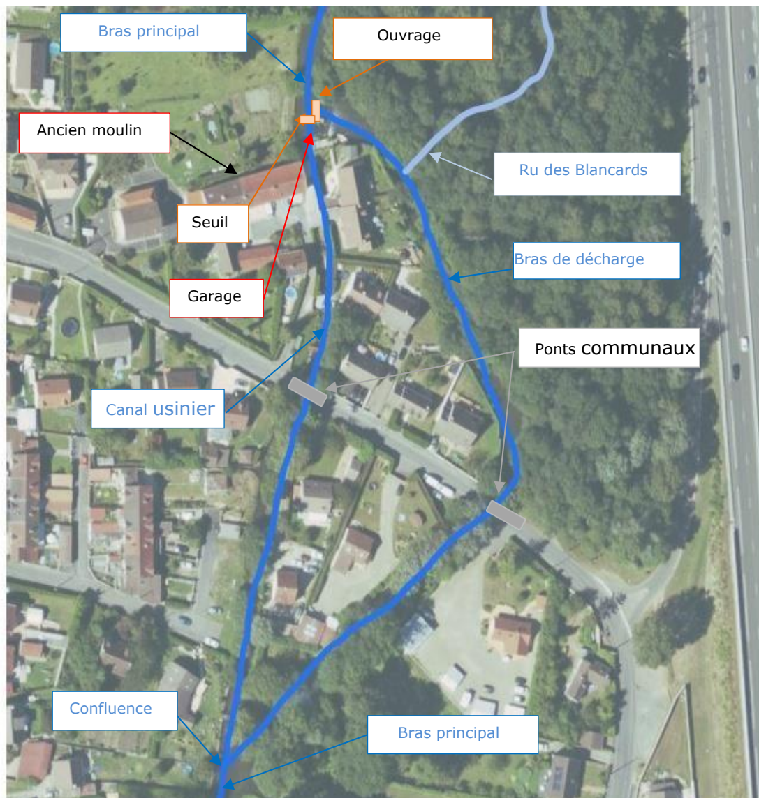
Description du site hydraulique du moulin de la Commanderie (source Géoportail orthophotographies)
