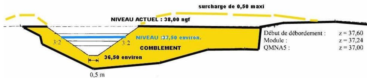
Figure 22- Profil en travers type du bief de confinement.
