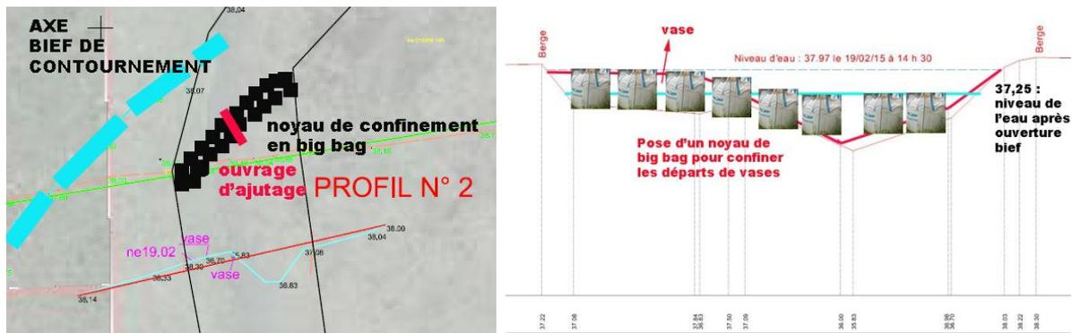
Figure 37.- Positionnement du noyau de big bag en confinement des vases.
