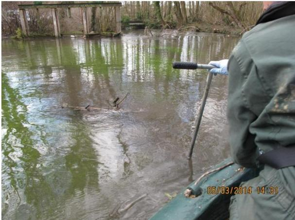
*Prélèvement au carottier à piston*
